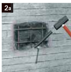
3 Retirada del hormigón Biselar los bordes
