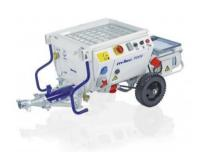
Bomba helicoidal de rotor compacta, p. ej. MTEC P20 400 V. Con una presión máxima de 30 bar y un máximo de 30 m de manguera. Puede requerir un mezclador externo.
