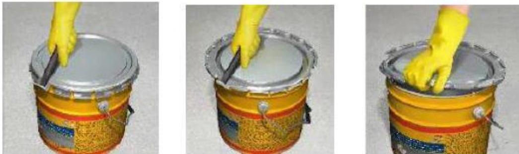
Use un destornillador resistente para abrir cada pestaña hasta que se pueda abrir la tapa. El material reacciona con la humedad del aire y no se puede reutilizar tras 2 – 3 días una vez abierto.
