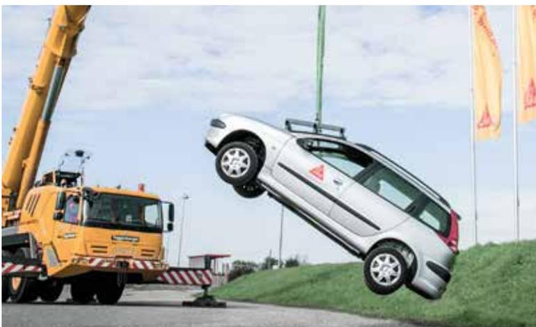
Con SikaTack® ELITE, un coche puede ser levantado por su parabrisas sólo 60 minutos después de la instalación.
