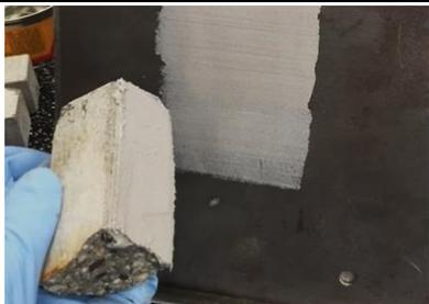
Aplicar una capa de adhesivo sobre la pieza a pegar, de 1 a 5 mm dependiendo de la rugosidad de la superficie.
