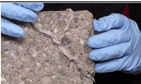
Presione las dos piezas con firmeza para que el exceso de resina salga por los lados. Retire el exceso de resina.
