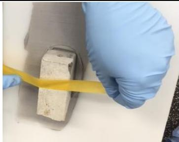
Presione las dos piezas con firmeza para que el exceso de resina salga por los lados. Eliminar el exceso de resina.
