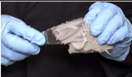
Aplicar una capa de adhesivo sobre la pieza a pegar, de 1 a 5 mm de espesor según la rugosidad de la pieza
