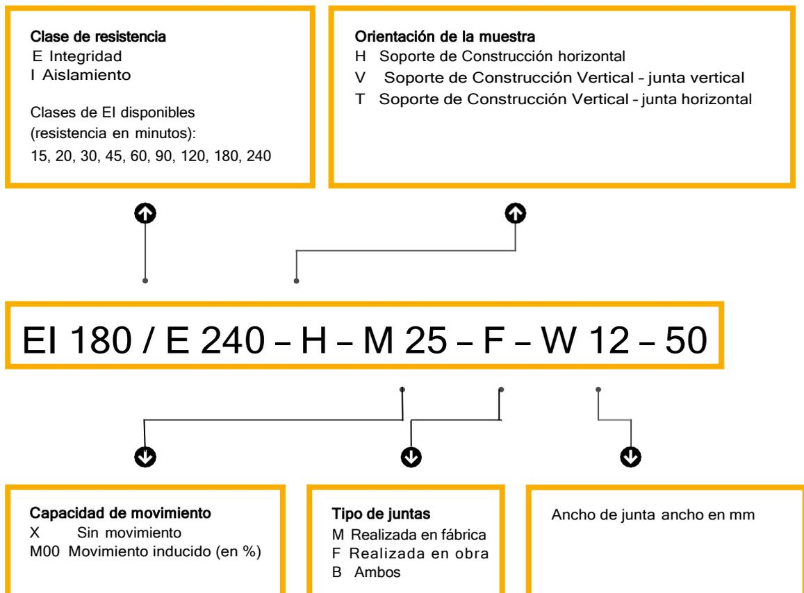
Es posible que le hagan la pregunta: "¿Es su sellador de junta resistente al fuego capaz de adaptarse al movimiento?" ¡Ten cuidado! - No es suficiente utilizar un sellador de juntas elástico con la capacidad de movimiento requerida (por ejemplo, según ISO 11600 o ASTM C 920); porque también se deben realizar pruebas específicas de resistencia al fuego (por ejemplo, según EN 1366-4) bajo movimiento forzado.
