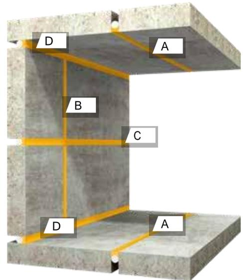
Junta de pavimento horizontal que linda con una pared
