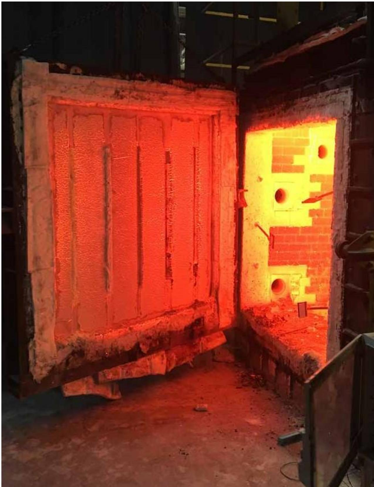
Horno con selladores lineales verticales después de prueba de resistencia al fuego acc. EN 1366-4
