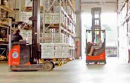
Fig. 8.7.3: Las superficies de soleras industriales también experimentan una fuerte abrasión debido a la rodadura constante y las cargas dinámicas en los mismos lugares. Los recubrimientos y endurecedores especiales pueden mejorar el agarre y minimizar el desgaste.
