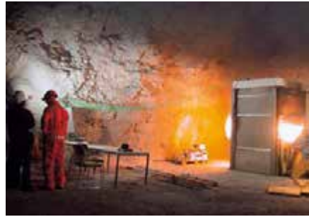
Fig. 8.5.1: En cámaras de horno especiales, las trayectorias del fuego se pueden replicar, los paneles se prueban y luego se evalúan. El desarrollo de la temperatura se mide y registra a varias profundidades
