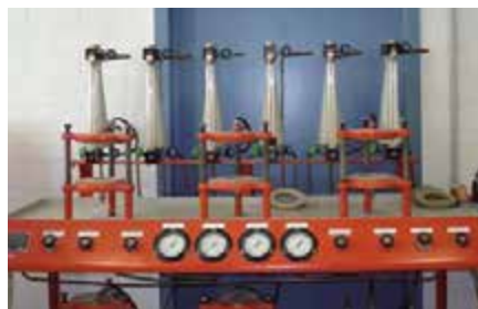
Fig. 8.1.1: La absorción de agua del hormigón bajo presión mide la penetración máxima de agua en mm después de un tiempo definido con una presión especificada. (72 horas con 5 bar según EN12390-8)
