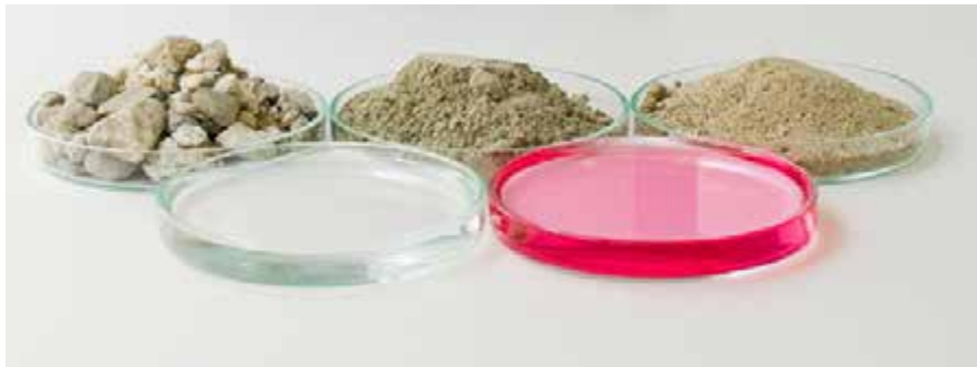
Fig. 4.2.2: Diseño de mezcla de ingredientes de hormigón: áridos gruesos, agua, cemento, superplastificante, arena (de izquierda a derecha)
