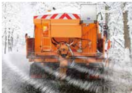
Fig. 8.3.3: La sal fundente dispersa intensifica considerablemente la reacción al congelar el agua y provoca un daño sustancialmente mayor en las áreas de hormigón cercanas a la superficie.
