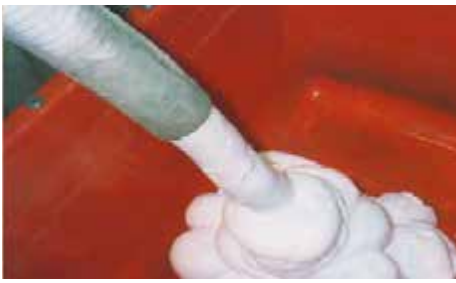
Fig. 8.15.2: Espuma generada por un generador de espuma y Sika® Stabilizer Poro para producir hormigón celular / espumado.
