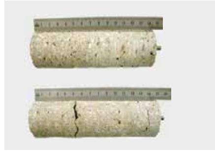
Fig. 8.4.1: deterioro del hormigón o debido al ataque de sulfatos muestra un fuerte aumento de longitud debido al ataque de descascarillado. Las primeras fisuras han aparecido en la muestra
