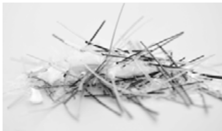
Fig. 8.11.1: Las fibras para su uso en hormigón se producen a partir de diferentes materiales y calidades de estos materiales, además de que pueden tener diferentes dimensiones geométricas y forma, de acuerdo con el rendimiento requerido del hormigón fresco o endurecido.
