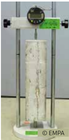
Fig. 8.6.2: El aumento del volumen debido a la tensión resultante de ASR se vuelve perceptible mediante la medición de un cambio en la longitud de las muestras de ensayo. Normalmente, las muestras se almacenan en condiciones extremas (temperatura, humedad, carga aplicada) con el fin de acelerar la reacción.
