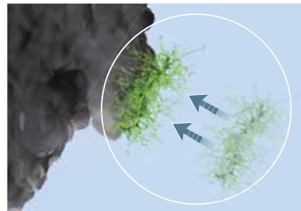
Detalle de la adsorción del polímero (cadena principal) en el grano de cemento.
