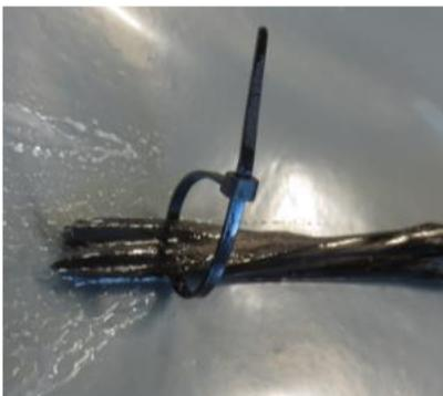
Proceda a atar las fibras con una brida o cable en un extremo y corte el sobrante de la brida o cable.
