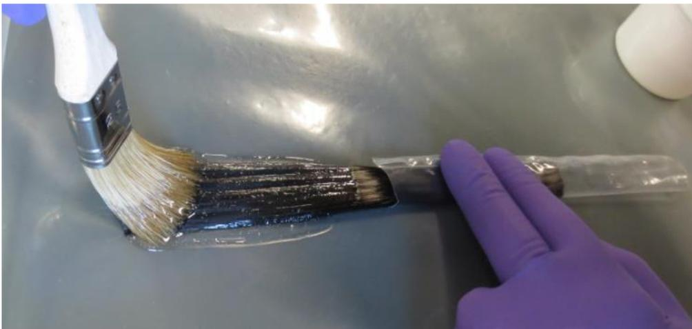
Impregne una mitad del conector con la resina hasta su completa saturación, elimine el exceso de resina.
