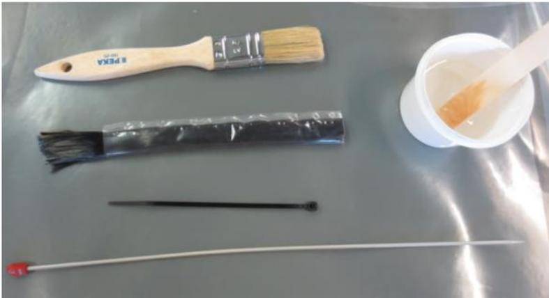
Corte el cordón en la longitud deseada y mezcle las resinas a emplear siguiendo las correspondientes fichas técnicas.
