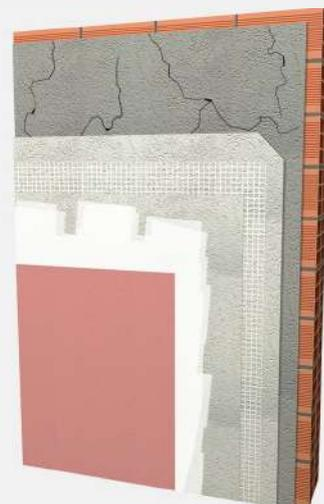
EJEMPLO DE SISTEMA SOBRE SOPORTE DE MONOCAPA RASPADO
