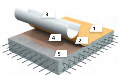
**El sistema post-aplicado SikaProof® P-1201**, la membrana se instala sobre el adhesivo recién aplicado sobre la superficie de hormigón endurecido ya preparada. No se requiere imprimación, el adhesivo crea una unión completa y altamente duradera con la estructura de hormigón.
