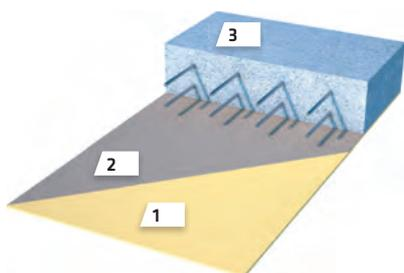
**El sistema post-aplicado SikaProof® P-12** se instala retirando primero el revestimiento protector y pegando la membrana directamente sobre la superficie de hormigón endurecido. La unión de toda la superficie con el hormigón se ve reforzada por la imprimación del sistema, que garantiza una adhesión duradera a la estructura de hormigón.
