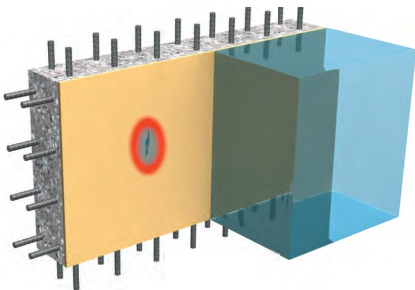
La "tecnología totalmente adherida" ha sido ensayada y aprobada en pruebas de funcionamiento según las normas ASTM y EN. Por lo tanto, la membrana adherida en combinación con el hormigón se ensaya en relación a su resistencia a la migración lateral del agua bajo una presión de agua definida durante un período específico.
