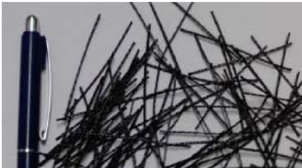
Foto 4.- Fibras sintéticas estructurales Sika Fiber T 48 empleadas en la obra
