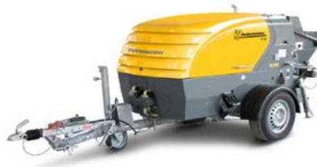
P715 TD: Bomba de pistón de accionamiento hidráulico diesel
