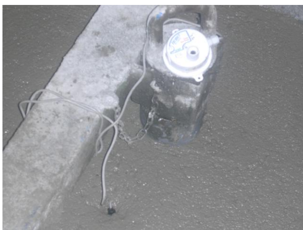
Foto 4.- Sonda de temperatura colocada en el murete de un túnel
