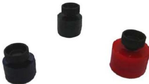
Demostración de como se usan los diferentes imanes para detectar y medir el espesor del recubrimiento de las armaduras en las estructuras de hormigón.
