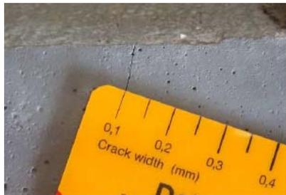
Usar una de las fisuras existentes en el bloque demostrativo de hormigón para visualizar el proceso de medida de la fisura.
