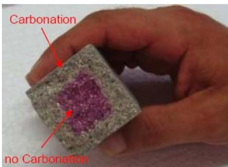
Usar los dos prismas de hormigón para mostrar las diferentes resistencias a la carbonatación. Ambos prismas han sido almacenados en las mismas condiciones climáticas con 1% de CO<sub>2</sub> de acuerdo con la Normativa Europea EN 13295. El área rosa refleja una alta alcalinidad (no carbonatación), el área incolora (alrededor del área coloreada) refleja un hormigón carbonatado.
