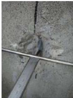
Colocar el pie de rey (calibre) especialmente fabricado, en la posición ortogonal a la armadura. Mover la regla del calibre para medir la profundidad de la armadura.
