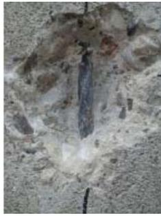
Limpiar el polvo generado en la superficie del hormigón con una brocha o un soplador. La superficie debe estar completamente libre de polvo o partículas sueltas. Una limpieza incorrecta nos llevará a unos resultados incorrectos de la medida de la profundidad de carbonatación.
