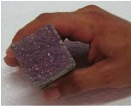
La primera figura muestra un mortero de reparación con baja resistencia a la carbonatación. La profundidad de carbonatación en este ejemplo es de aproximadamente 8mm.
