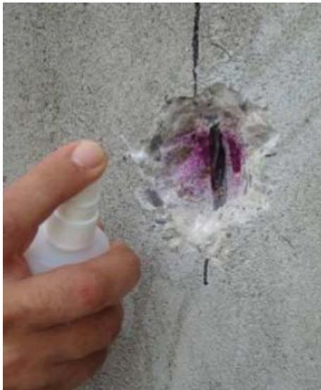
En la obra, se usa un spray con una solución de fenolftaleína para visualizar la profundidad de carbonatación sobre la superficie picada del hormigón. El área altamente alcalina se coloreará rápidamente de color rosa.
