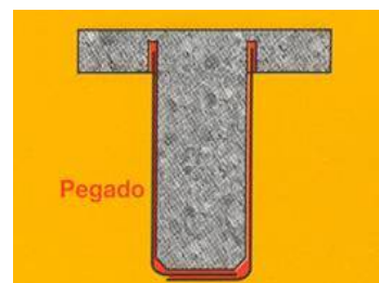
Fig. 7.17. Detalle de los angulares colocados
