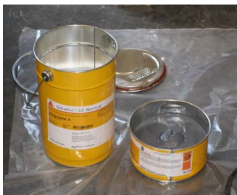
Fig. 6.1. Componente A-B del Sikadur®-30
