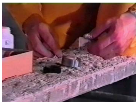
Fig. 5.12. Aplicación de la resina en la sufridera
