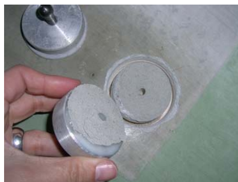
Fig. 5.13. Corte realizado con una taladradora con corona de diamante
