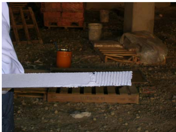
Fig. 7.4. Detalle de las acanaladuras del angular
