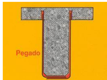
Fig. 7.15. Esquema de trabajo, paso 2: Pegado del angular sobre el soporte
