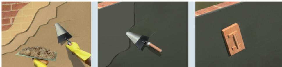
MORTERO DE IMPERMEABILIZACIÓN APLICABLE CON BROCHA Y POR PROYECCIÓN. GENERA UNA ESTRUCTURA DE CRISTALES EN EL HORMIGÓN QUE TAPONA LA RED CAPILAR.
