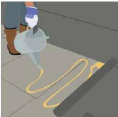
Selle los lados y los bordes con un cordón del adhesivo Sikalastic® Coldstick y use una espátula para eliminar y extender el exceso de adhesivo.
