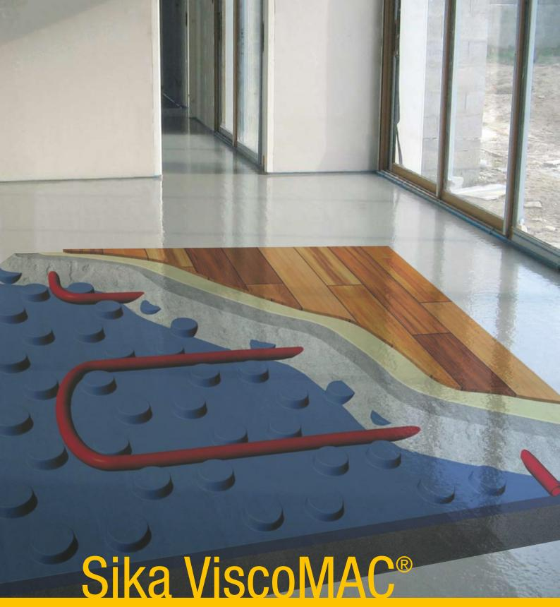
**Mortero Autonivelante Conductivo**
