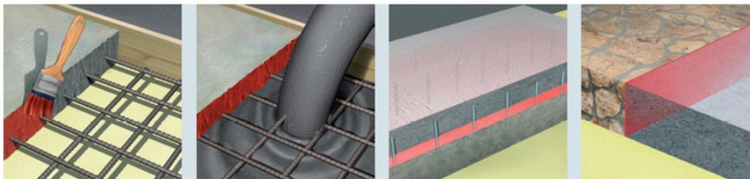
SIN DISOLVENTES. APLICADO SOBRE SUPERFICIES DE HORMIGÓN VIEJO PROPORCIONA UNA UNIÓN PERFECTA CON HORMIGÓN FRESCO.
