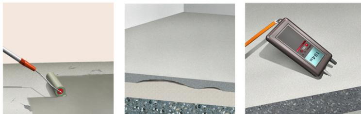
MORTERO CEMENTOSO MONO COMPONENTE PARA SER RECUBIERTO Y APLICABLE EN ESPESORES DE 0,5-15 MM O DE 15-30 MM CON ÁRIDO AÑADIDO.
