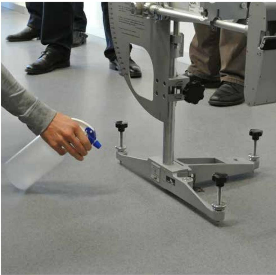
Imagen 1: Ensayo del péndulo TRRL.
