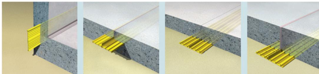
DE UN MATERIAL FLEXIBLE (TERMOPLÁSTICO), CON DIFERENTES SECCIONES Y DIMENSIONES EN FUNCIÓN DE SU COLOCACIÓN Y SOLICITACIONES A LAS QUE VA A ESTAR SOMETIDAS.
