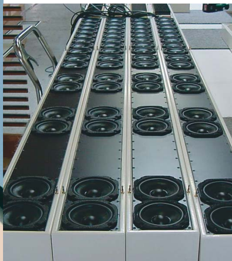
Producción eficaz en las cabinas de los altavoces. Pegado de los paneles frontales dentro de cajas metálicas, eliminando fijaciones mecánicas, y ofreciendo un mejor acabado.
