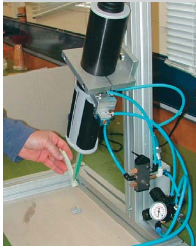
Instalación de una pistola neumática fija que simplifica el pegado de partes pequeñas.
