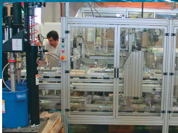
Integración de SikaFast® en una línea automatizada de producción usando una bomba y un sistema de dosificación.
