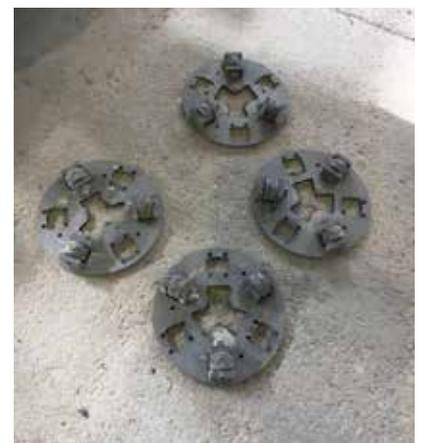
El sistema SikaScreed® HardTop-60 system requiere un soporte preparado. El soporte de hormigón fue preparado utilizando una máquina HTC equipada con una herramienta especial de abujardado "HTC Ravage"
