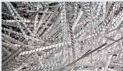
SikaFiber® Force (macro fibra sintética). Tamaño  $\Phi$  1.0 mm, longitud 54 mm. Dosificación: 3 - 8 kg/m<sup>3</sup>.
