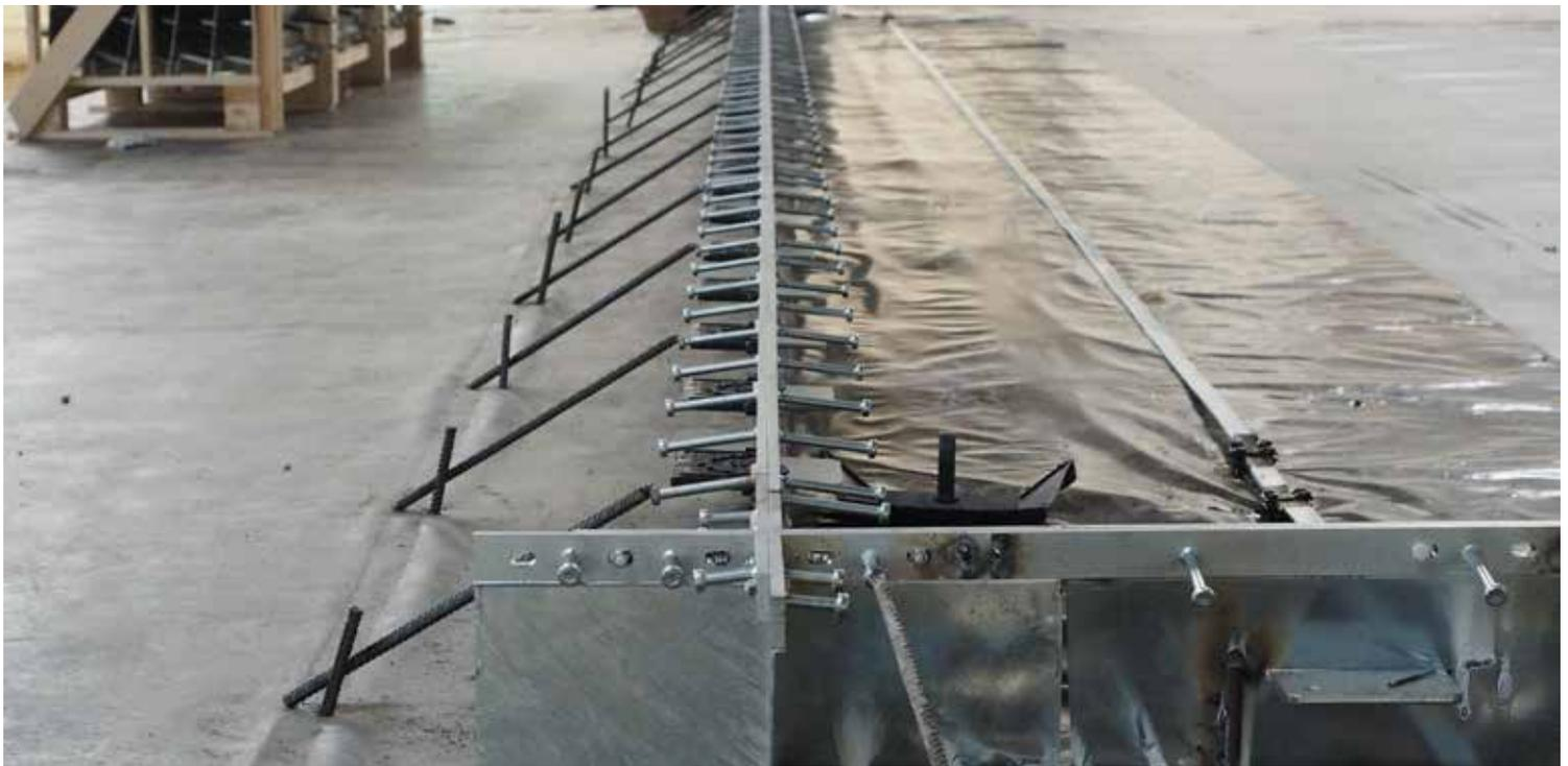
Solución de juntas de libre movimiento del Grupo Peikko®. TERAJOINT® es un sistema prefabricado de juntas para dejar preparado en la obra, diseñado para construir juntas de libre movimiento, compuesto por bordes de refuerzo de gran resistencia, encofrado permanente y un sistema de transferencia de carga. Es adecuado para todos los métodos de construcción, para pavimentos de hormigón sobre cimentación o sobre pilotes..
