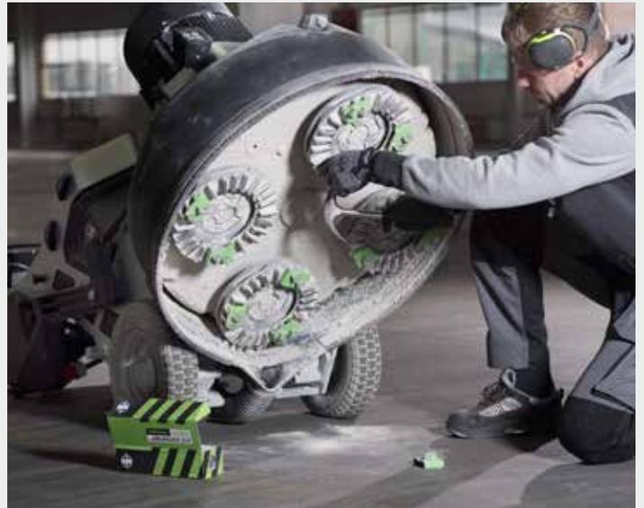
Un operador cambia los discos abrasivos de metal adiamantado en una máquina de pulido HTC DURATIQ. La serie de herramientas Superprep verde está específicamente desarrollada para los trabajos duros de preparación del pavimento.
