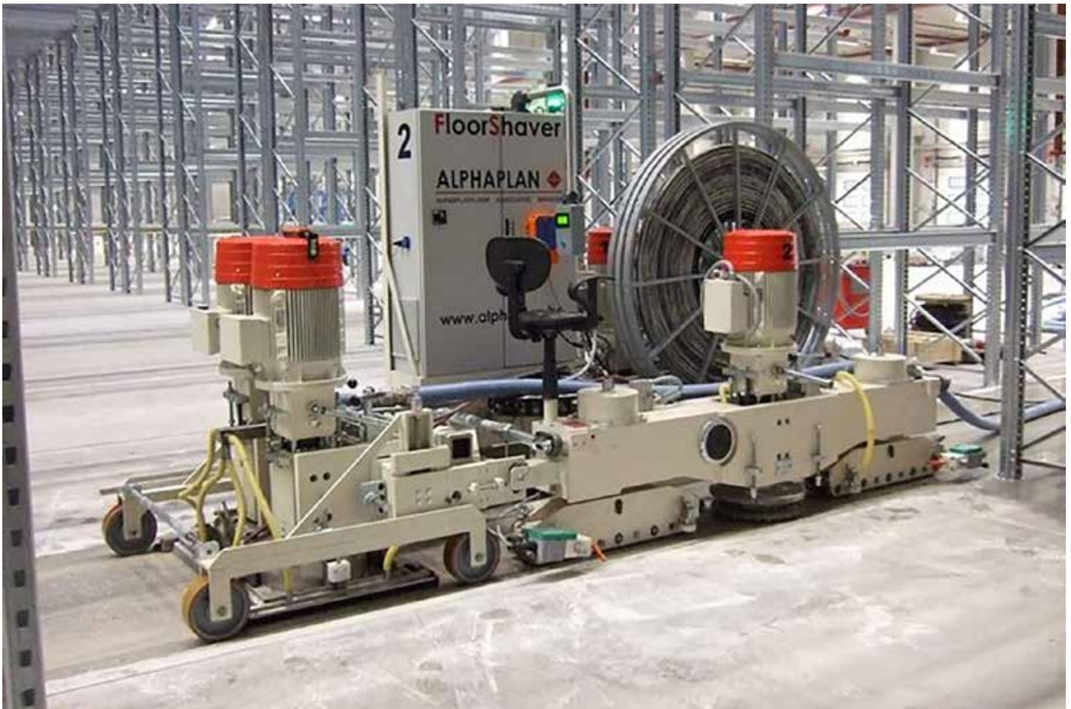
Robot de pulido AlphaPlan FloorShaver produciendo una superficie ultra plana rápidamente y sin polvo.
