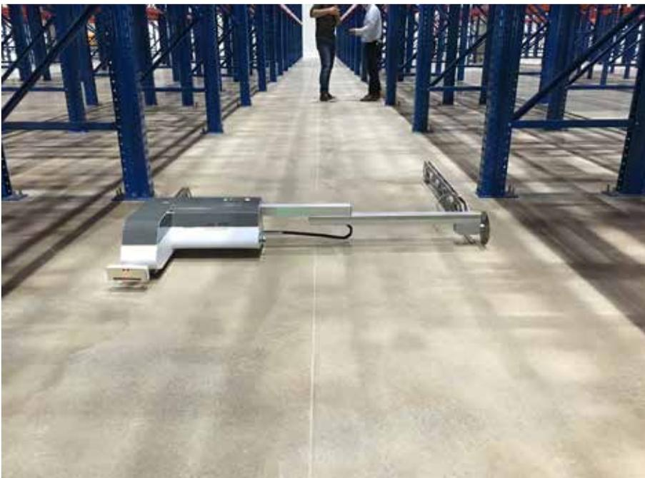
Robot perfilógrafo AlphaPlan guiado por láser para la medida de tolerancia del pavimento en acción
