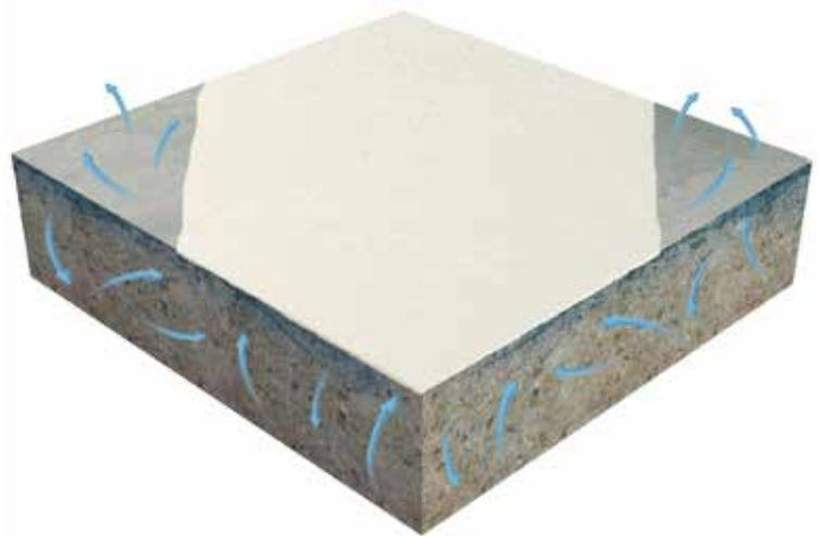
Principio de curación efectiva de suelos de hormigón. La membrana de curado reduce la evaporación del agua en la losa de hormigón en su fase inicial.
