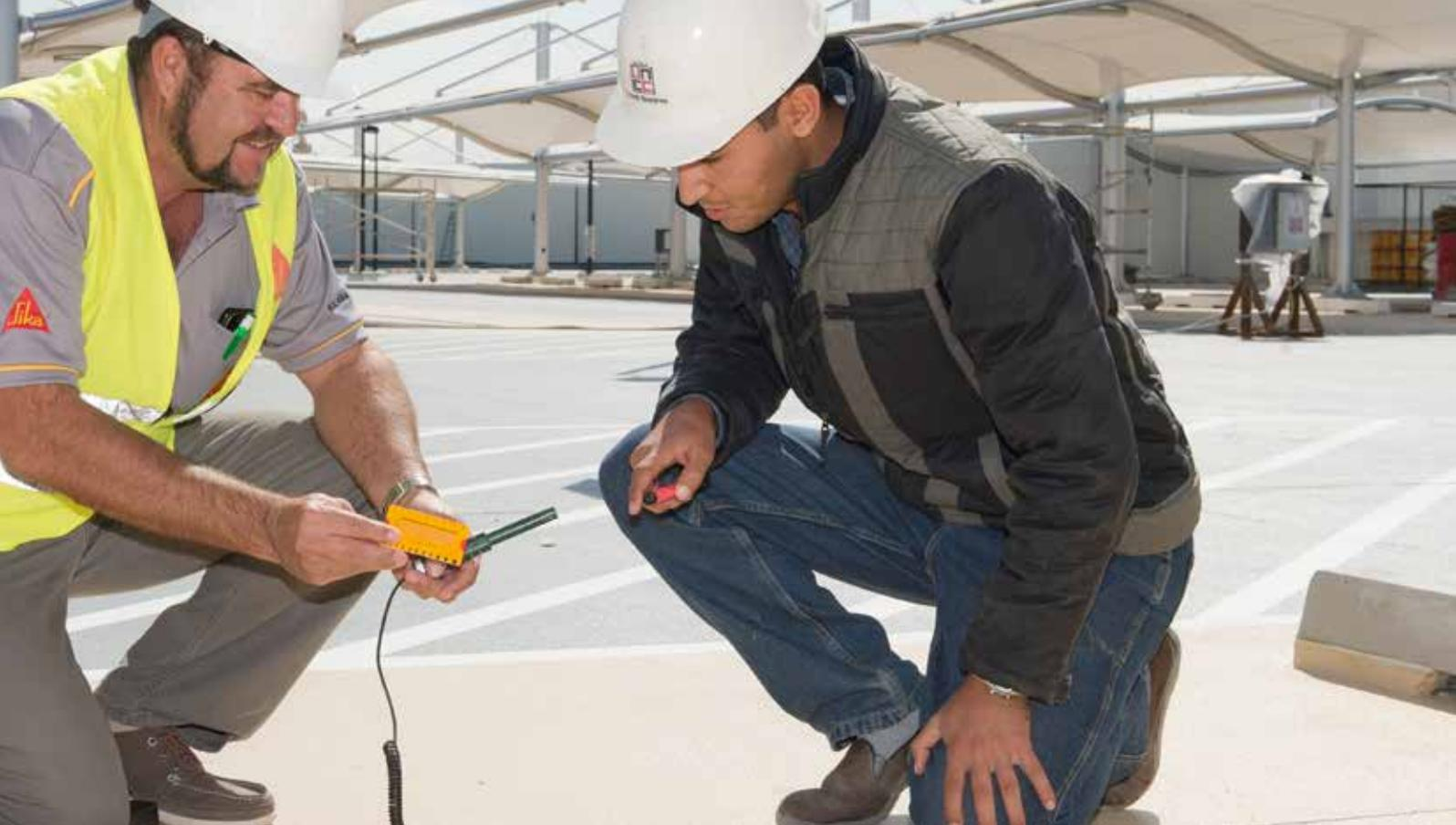
Antes de la aplicación de los acabados de pavimentos sensibles a la humedad, es importante medir y comprender el estado de humedad en el soporte. Sika tiene experiencia y conocimientos técnicos para ayudar y proporcionar soluciones sostenibles.
