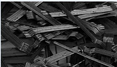
Fibras de acero. Tamaño normal  $\Phi$  1.0 - 1.5 mm, longitud 35 - 45 mm. Dosificación: 20 - 45 kg/m<sup>3</sup>.
