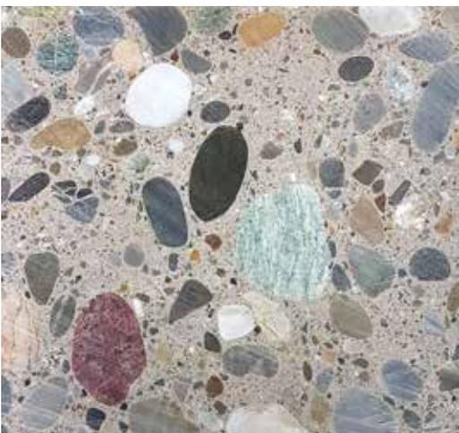
Corte de sección de hormigón endurecido.
