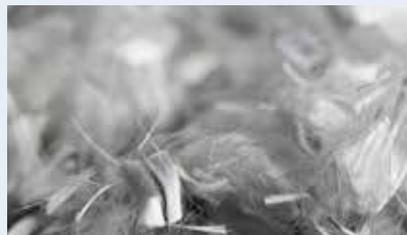
SikaFiber® (micro fibra sintética). Longitud normal 6 - 12 mm. Dosificación: 0.6 - 0.8 kg/ m<sup>3</sup>.
