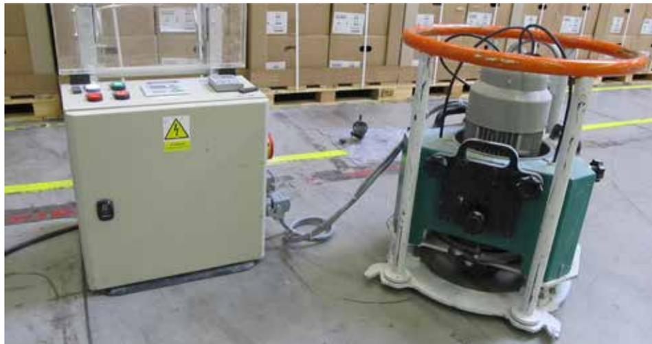
Equipo de test para medir la resistencia al desgaste de un suelo de hormigón según la norma EN 13892-4.
