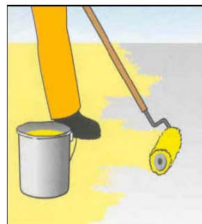
Aplicación de la capa lisa de imprimación Sikafloor-264 con rodillo de pelo medio/largo o brocha, p.e. rodillo o brocha Polyplan.
