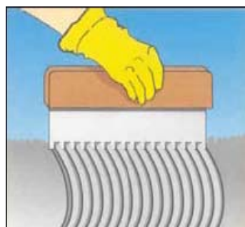
Extender Sikafloor 264 con llana dentada. P.e. llana dentada polyplan 5/7 mm.
