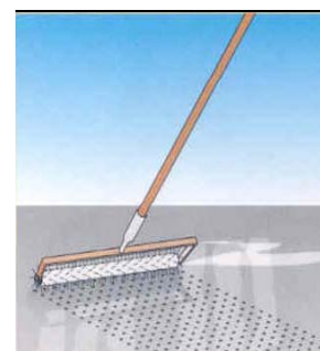
Pasar inmediatamente el rodillo de púas para eliminar el aire ocluido. P.e. rodillo de puas Polyplan.
