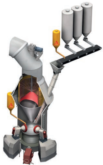
Molino de rodillos vertical
